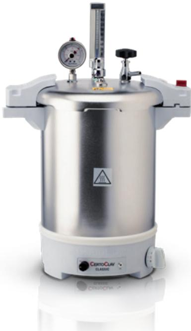
Die 2. Generation unserer Laborautoklaven wartet mit einem neuen Design, mehr Funktionen und einer neu entwickelten Touchscreen-Steuerung auf. Die Dampfsterilisatoren bestechen durch ihre solide Bauweise, zudem sind sie äußerst wartungsarm. Die Entlüftung erfolgt durch Strömungsverfahren oder fraktioniertes Entlüften.
