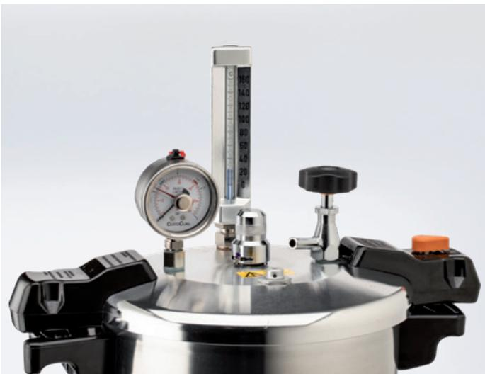
Bereits nach wenigen Handgriffen sind unsere Laborautoklaven startklar. Die Sterilisationskammer lässt sich sicher und leicht mit einem Handgriff öffnen und schließen; einfach Deckel drehen und abnehmen. Sie sind transportabel und standortunabhängig. Es wird lediglich eine Stromversorgung benötigt. Die Wasserversorgung erfolgt mit einem Gemisch von Leitungswasser und demineralisiertem Wasser.
